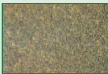
Мелкозернистый сплав (2000 x)
